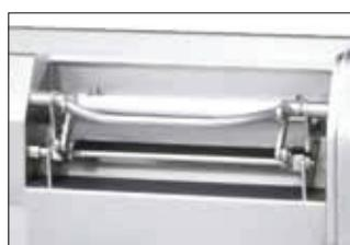
Режущая заслонка совершает криволинейное движение. Только таким образом достигается практическое обслуживание одной рукой и максимальное заполнение камеры.
