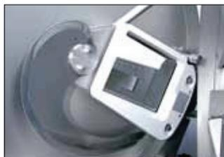
Если посмотреть внутрь ножевой камеры, виден тонкий нож точного резания.
