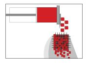
AVS (автомат. предварительного уплотнения) позволяет, с самого начала, добиться оптимальной точности формы кубиков или брусков. Кроме этого, она служит оптимизации времени циклов, посредством, например, быстрейшего процесса в незаполненных отделениях камеры.
