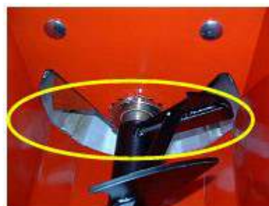
Рис.2: Машина установлена для «мокрого» EPS. Дробилка поворачивается на 180 град.
