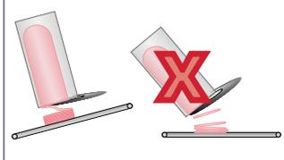
Комбинация из уникальнейшей в мире технологии SAS с наклонным лотком и инновационной технологией производства ножей, TREIF гарантирует оптимальную укладку, даже при «тяжёлых» продуктах, как напр. птица.
